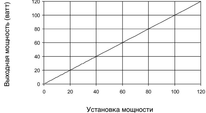
Зависимость выходной мощности от установки мощности в режиме Fulgurate (прижигания)
