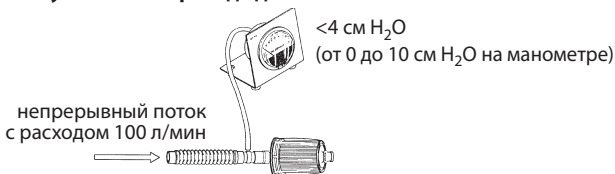
Рис. 1. Контрольная установка перепада давления
